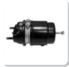
CILINDRO COMBINADO BRAKE CHAMBER KNOOR TYPE
