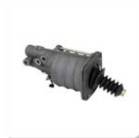
SERVO EMBREAGEM STRALIS CLUTCH SERVO IVECO STRALIS
