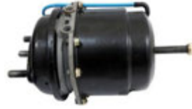
DIAFRAGMA 7" = TIPO G= DIAFRAGMA 7" PULMON DE AIRE = TIPO G= DIAPHRAGM 7"
